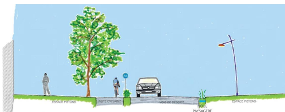
Exemple de profil de voirie avec voie structurante, piste cyclable, espace piéton et noue paysagère
